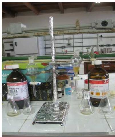
Figura 6. Procedimento de extração líquido-líquido com éter e AcOEt.
