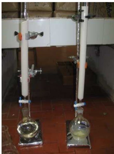
Figura 5. Colunas com Amberlite XAD-2 usadas na separação das substâncias fenólicas
