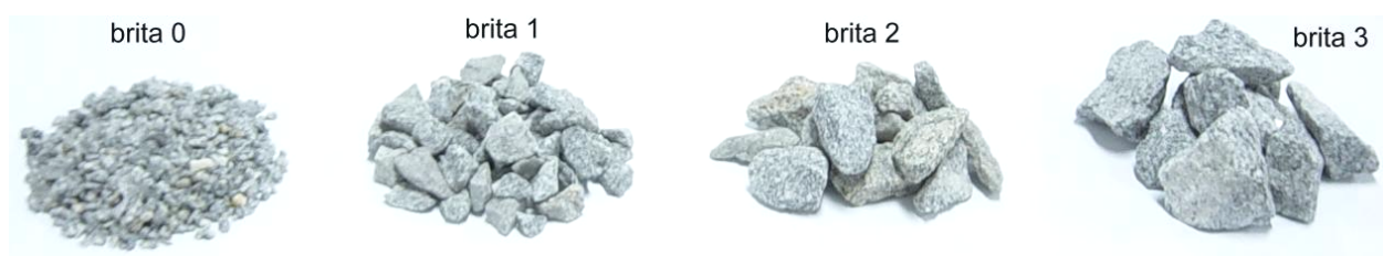
Figura 3 – Agregado graúdo (pedra granítica britada).
