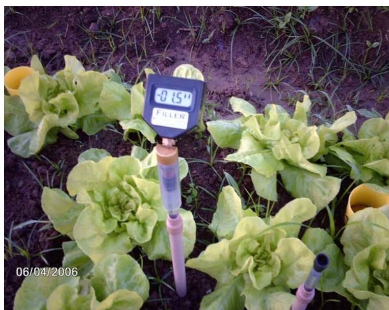
Figura 4 – Tensímetro da marca FILLER, utilizado para monitorar a tensão da água no solo.
