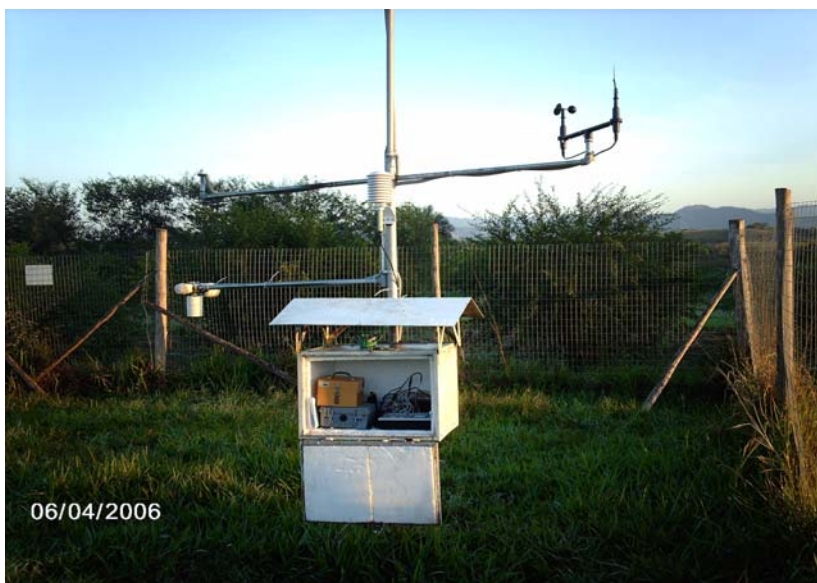
Figura 6 – Vista dos sensores da estação meteorológica automática instalada na área experimental do SIPA.
