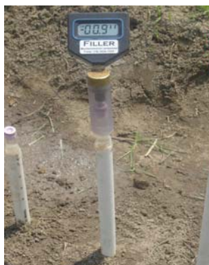
Figura 11 - Tensiômetro da marca FILLER, utilizado para monitorar a tensão da água no solo.
