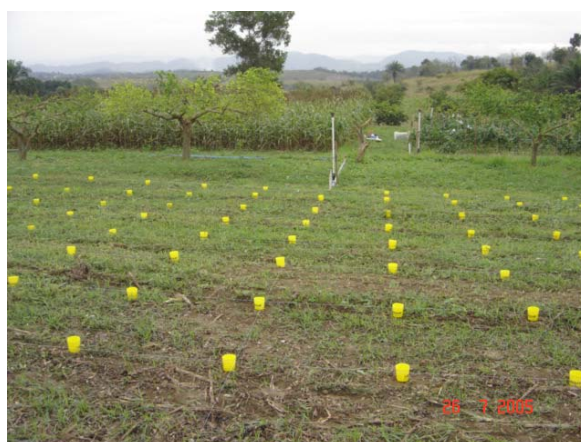
Figura 8 – Distribuição dos coletores nas parcelas para a realização do teste de precipitação e uniformidade de aplicação da água.
