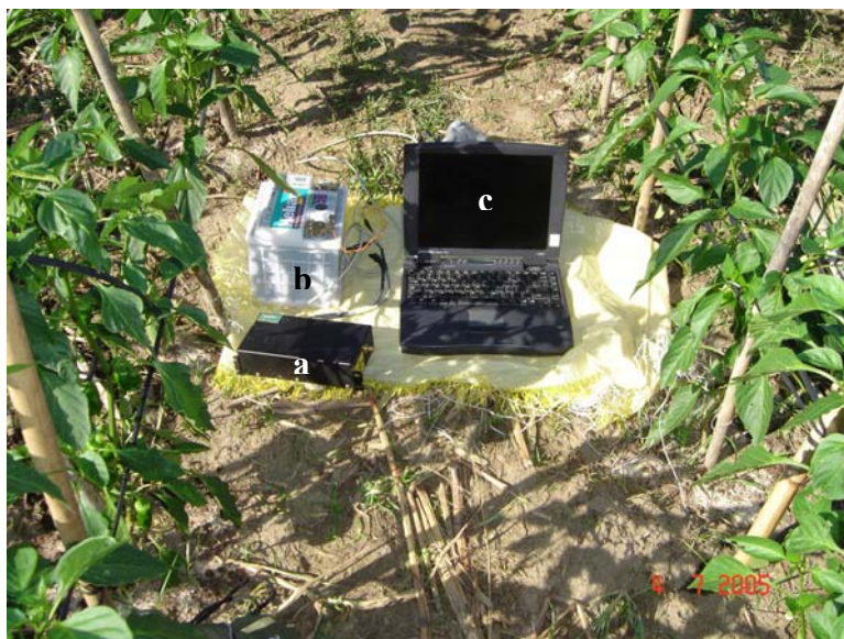
Figura 10 – Equipamento TDR constituído pelo osciloscópio (a), bateria de 12 v (b) e laptop (c) com programa para emitir os pulsos e fazer leitura da constante dielétrica.
