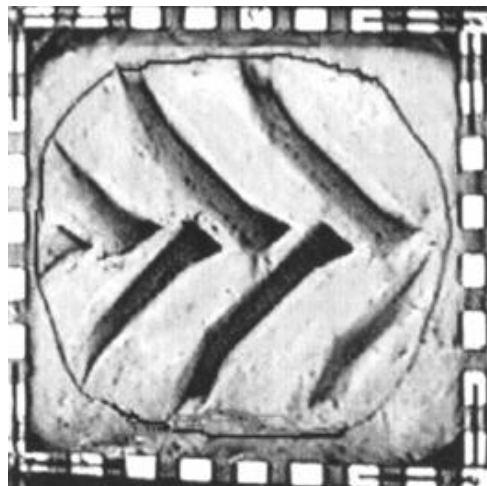
Figura 2 - Imagem obtida após a prensagem do pneu sobre o molde de argila. Fonte: SANTOS & LANÇAS (1999).
