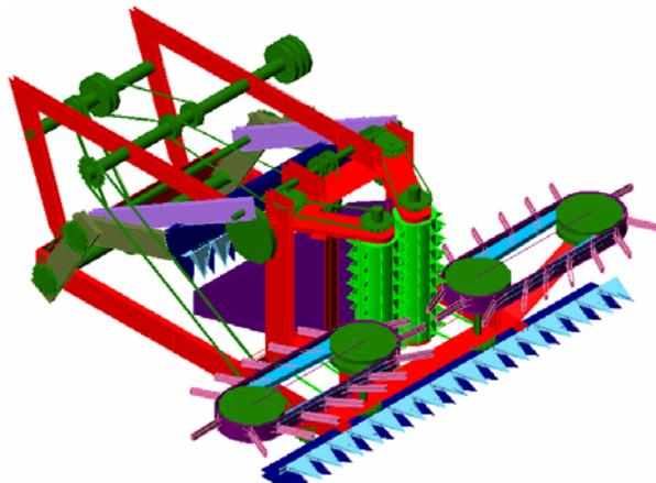
Figura 4. Solução conceitual da máquina cortadora-picadora de cobertura
