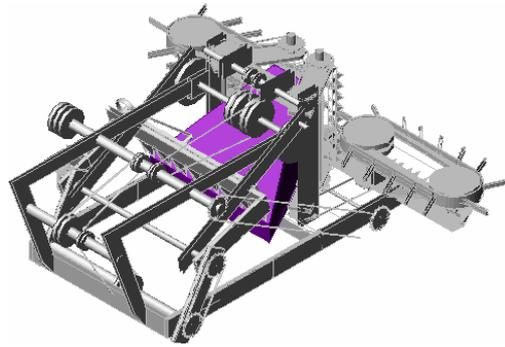
Figura 2. Direcionador de fluxo da cortadora-picadora de plantas de cobertura.
