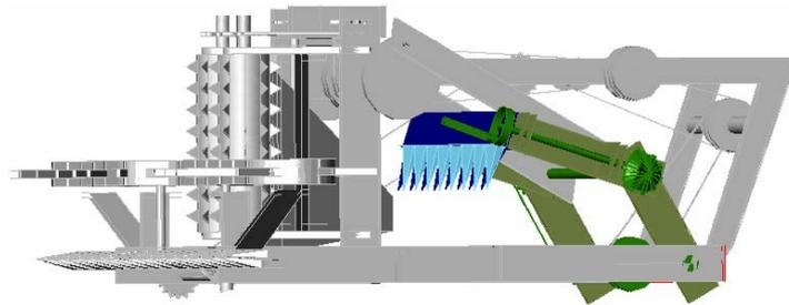
Figura 3. Picador da cortadora-picadora de plantas de cobertura.
