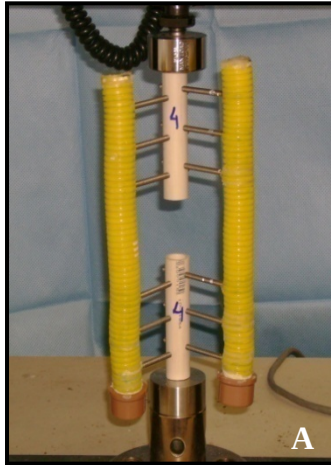
Figura 25 – Seqüência do teste de compressão axial do corpo de prova número quatro pertencente ao grupo E (corpos de prova com aparelhos de fixação esquelética externa confeccionados com barras de conexão de resina acrílica autopolimerizável e 12 pinos de inserção - seis por fragmento/ três por barra estabilizadora em cada fragmento). A) Início do teste, B) Após o término do ensaio, caracterizado pela falha do aparelho.
