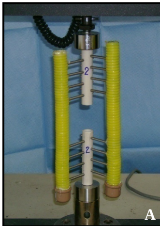
Figura 26 – Seqüência do teste de compressão axial do corpo de prova número dois pertencente ao grupo F (corpos de prova com aparelhos de fixação esquelética externa confeccionados com barras de conexão de resina acrílica autopolimerizável e 16 pinos de inserção - oito por fragmento/ quatro por barra estabilizadora em cada fragmento). A) Início do teste, B) Após o término do ensaio, caracterizado pela falha do aparelho.
