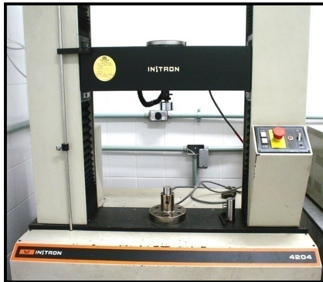
Figura 15 – Máquina de teste mecânico Instron modelo 4204, utilizada para promover compressão axial durante os ensaios.
