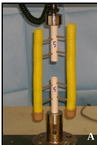
Figura 24 – Seqüência do teste de compressão axial do corpo de prova número cinco pertencente ao grupo A (corpos de prova com aparelhos de fixação esquelética externa confeccionados com barras de conexão de resina acrílica autopolimerizável e oito pinos de inserção - quatro por fragmento/ dois por barra estabilizadora em cada fragmento). A) Início do teste, B) Após o término do ensaio, caracterizado pela falha do aparelho.
